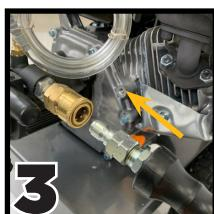
Conecte la manguera de alta presión a la salida de la bomba.
