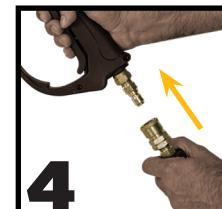
Brancher le pistolet de pulvérisation au tuyau haute pression.
