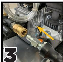
Brancher le boyau haute pression à la sortie de la pompe.
