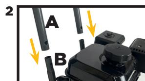
Deslice la manija del marco (A) sobre los postes inferiores de la hidrolavadora (B).
