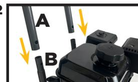
Emboîter la poignée du châssis assemblée (a) sur les montants de la laveuse à pression (b).
