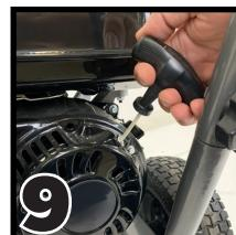
Tire del arrancador retráctil hasta que el motor arranque.
